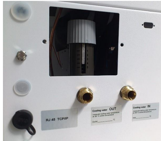
Bild 2 Offene Abdeckung des Kühlwassermengenreglers
